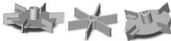
Gambar 2.5. Pengaduk Turbin pada Bagian Variasi.
