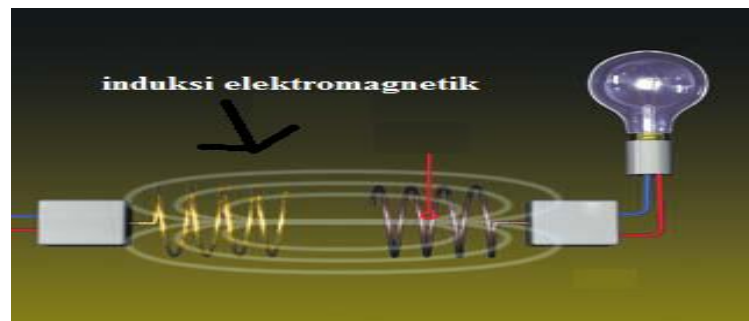
Gambar 2.3 Proses Induksi Elektromagnetik antar 2 Kumparan
