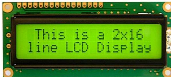
**Gambar 2.27** Bentuk Fisik LCD 16x2
