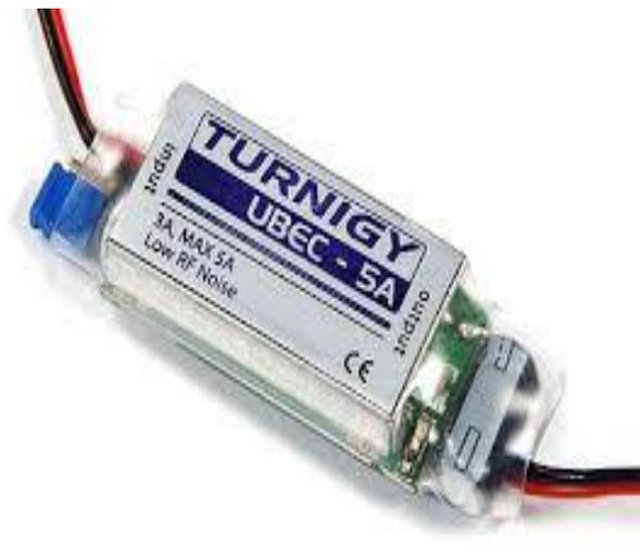
**Gambar 2.17** UBEC tegangan 5V
