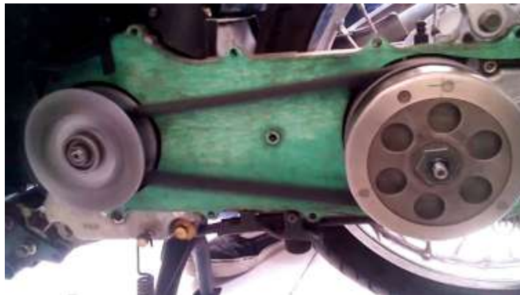
Gambar 2.3 CVT pada saat posisi stasioner
