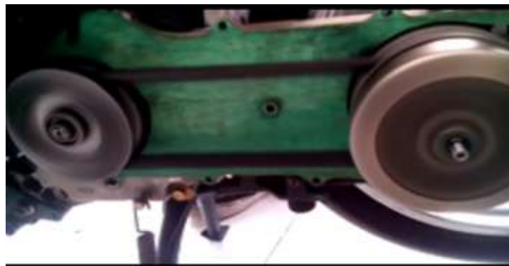
Gambar 2.5 Putaran menengah pada CVT
