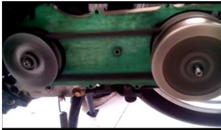
Gambar 2.6 Putaran tinggi pada CVT
