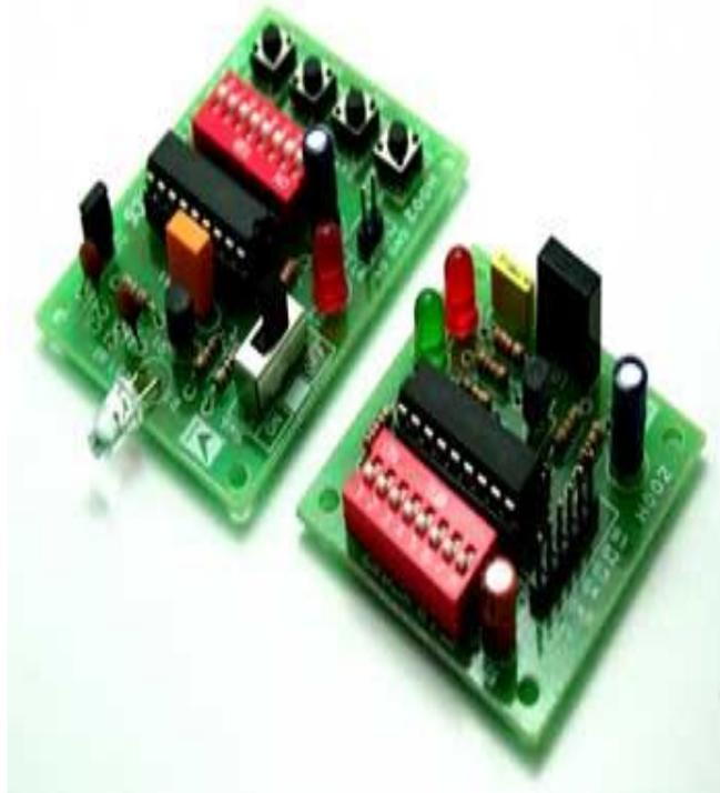
**Gambar 2.6** Radio Frekuensi 4 *Channel*
