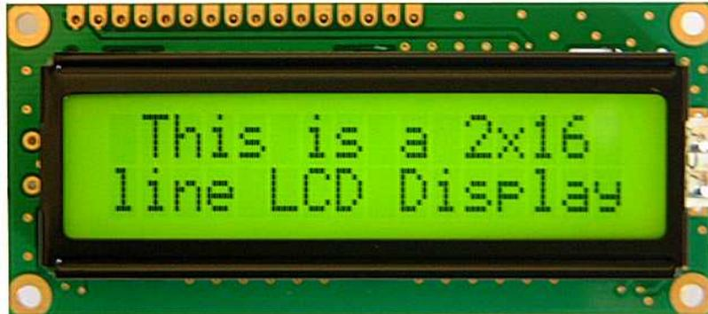
Gambar 2.9 LCD 16x2
