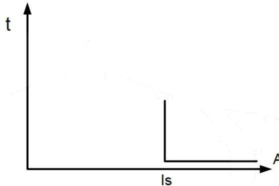
Gambar 2.9 .Karakteristik waktu seketika (waktu – arus)<sup>(3)</sup>
