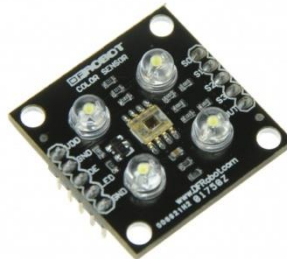
Gambar 2.6 Sensor warna TCS3200
