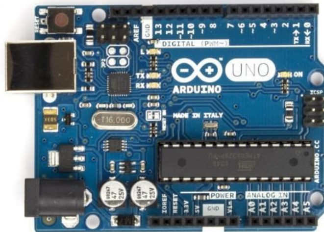
Gambar 2.8 Arduino UNO Tampak Depan (Sumber: Dinata, Yuwoono Marta, 2015: 3)
