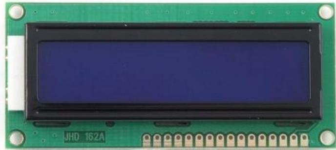
Gambar 2.10. Liquid Crystal Display
