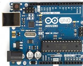
**Gambar 2.3.1. Bentuk Fisik Arduino Uno R3**
