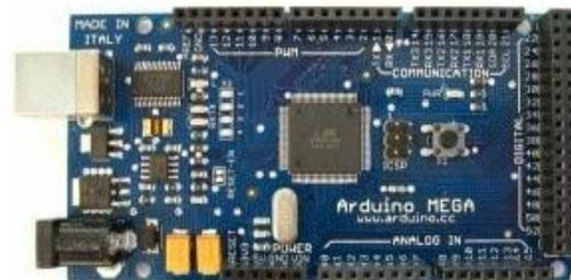
**Gambar 2.5 Bentuk Fisik Arduino Mega**
