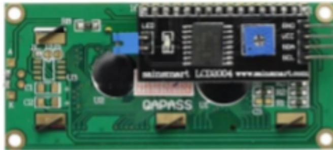
**Gambar 2.5** Liquid Crystal Display dengan Modul I2C
