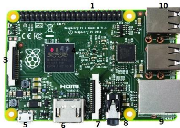
Gambar 2.2 Arsitektur Raspberry Pi Model B
