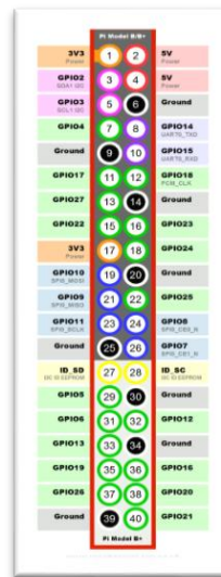
Gambar 2.3 Konfigurasi Pin GPIO Raspberry Pi 3 Model B
