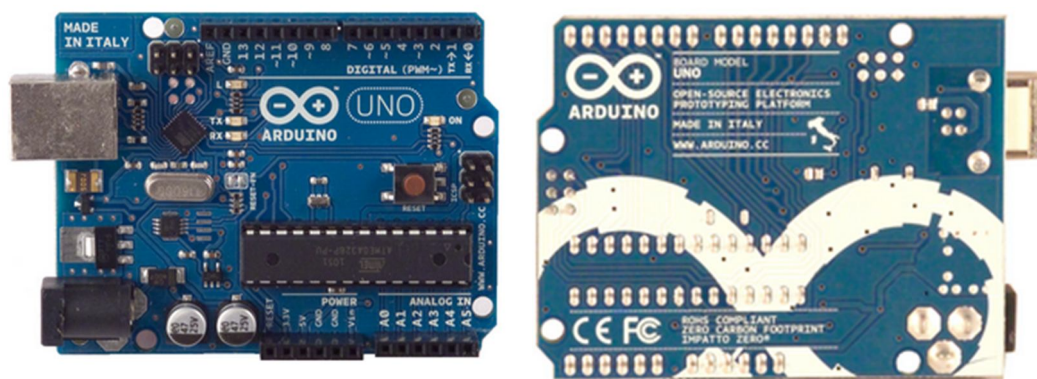
Gambar 2.5 bentuk fisik Arduino UNO
