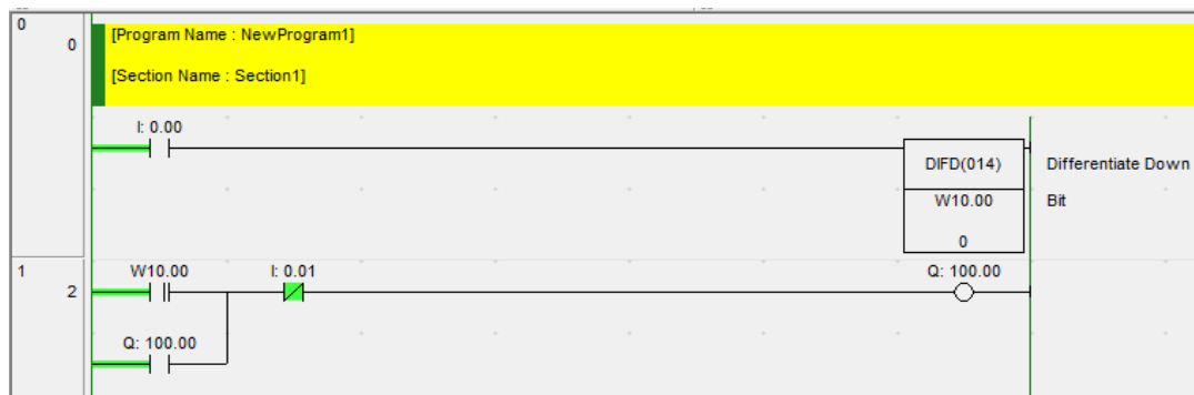
Gambar 2.19 Contoh Penggunaan Instruksi Kendali Bit DIFFERENTIATE DOWN (DIFD)
