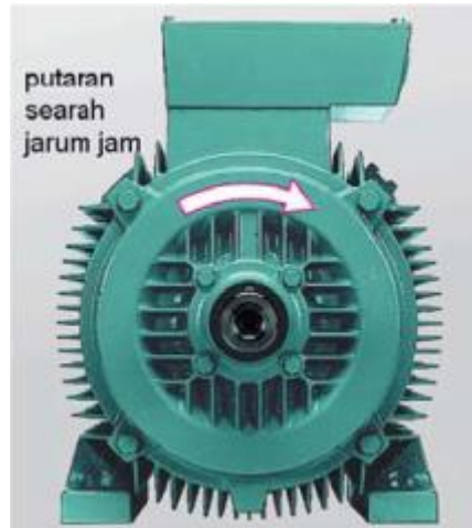
Gambar. 2.6 Putaran Motor Induksi
