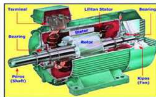
Gambar 2.2 Konstruksi motor induksi 3 phase
