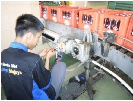
Proses Pengukuran Tegangan Pada Terminal Motor Induksi 3 Fasa
