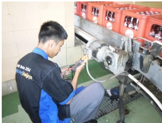
Proses Pengukuran Arus Pada Terminal Motor Induksi 3 Fasa
