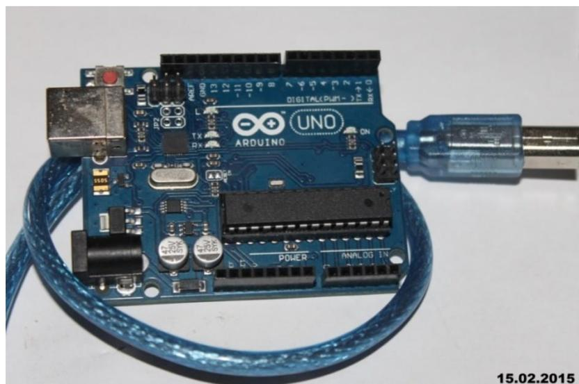
Gambar 2.2 Arduino Uno<sup>4</sup>
