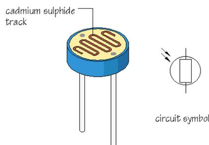
**Gambar 2.5 konstruksi LDR<sup>7</sup>**
