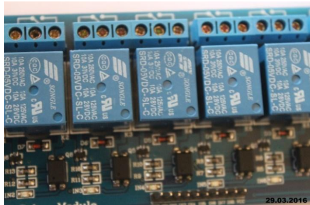
Gambar 2.7 Bentuk Fisik Dari Relay 5V/220V
