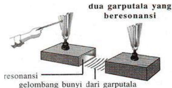
**Gambar 2.7** Resonansi Pada Garpu Tala
