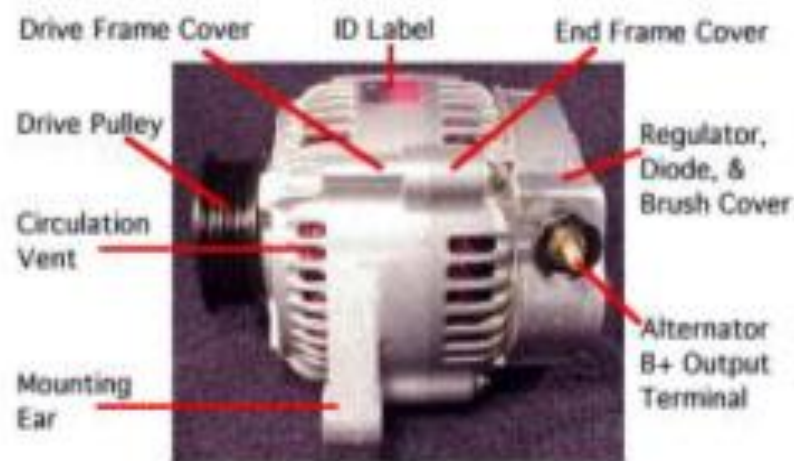
Gambar 2.4 Komponen Alternator
