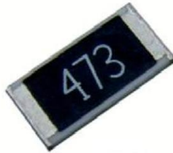
Gambar 2.15. Resistor Bentuk Komponen Chip
