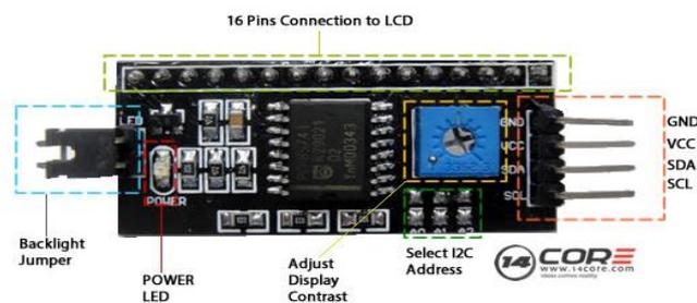
**Gambar 2.17** Wiring I2C Module Lcd 16x2
