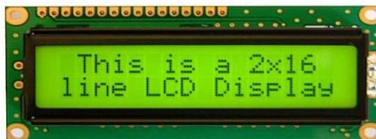
**Gambar 2.16** Bentuk Fisik LCD 16x2
