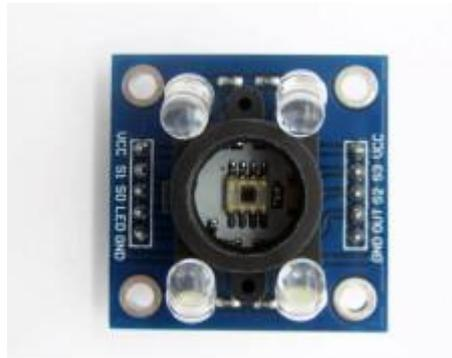
**Gambar 2. 13** Modul Sensor TCS3200
