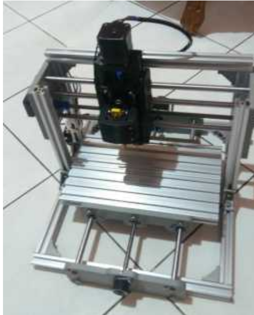
Tampilan Mesin CNC Router dengan Aplikasi GRBL 0.9 Control 3 Axis Sistem X, Y dan Z
