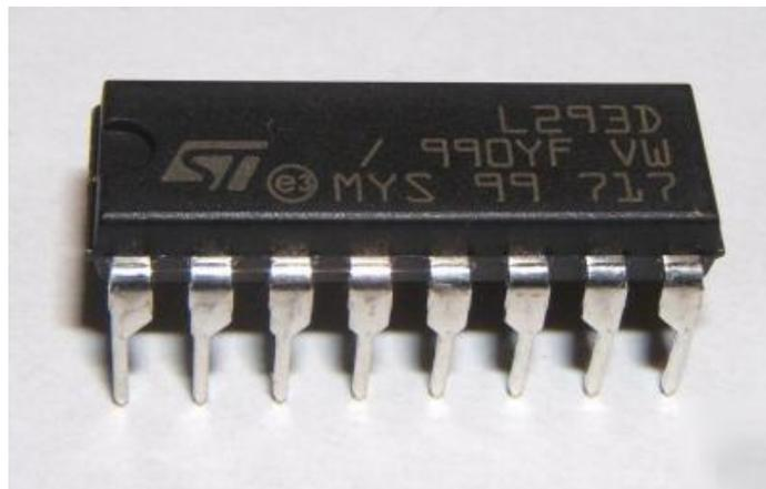
**Gambar 2.7** Bentuk Fisik IC L293D
