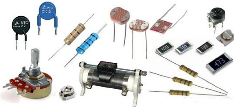
Gambar 2.12 Jenis-jenis resistor. (Suprianto, 2015).
