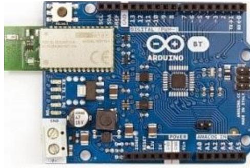
**Gambar 2.12 Bentuk Fisik Arduino BT**
