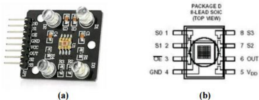
Gambar 2.5 (a) bentuk fisik sensor TCS230 (b) skema pin sensor TCS230
