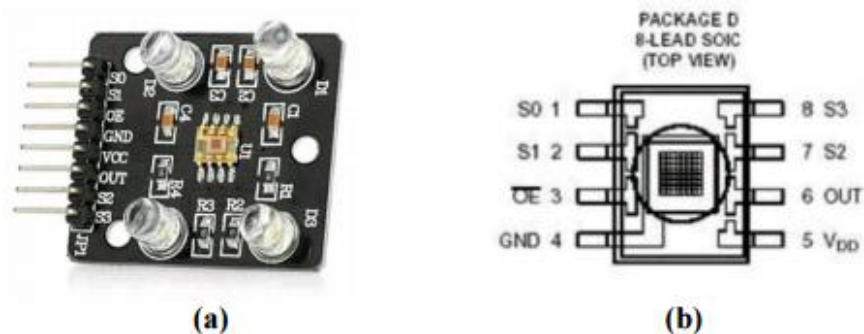
Gambar 2.4 (a) bentuk fisik sensor TCS230 (b) skema pin sensor TCS230
