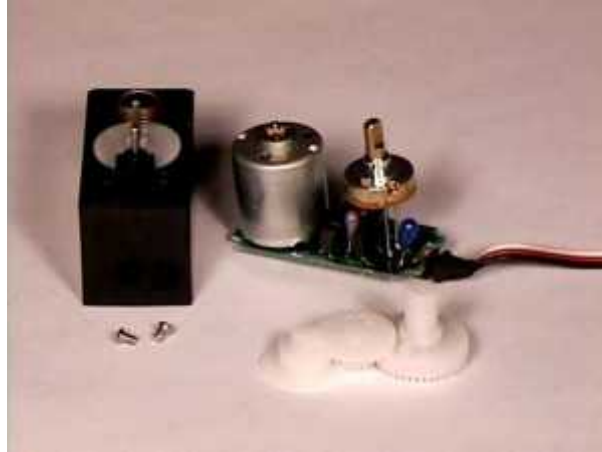
Gambar 2.4 Konstruksi Motor Servo
