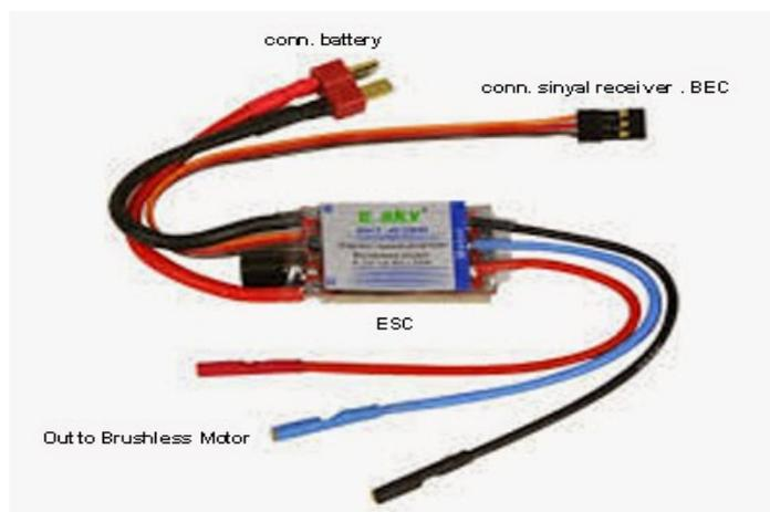
**Gambar 2.10** ESC (Elektronik Speed Control)
