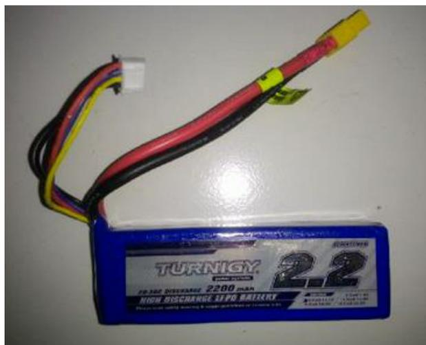
**Gambar 2.13** Baterai Li-Po 2200 mAh
