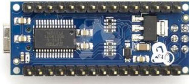
**Gambar 2.2** Tampak Depan Arduino Nano
