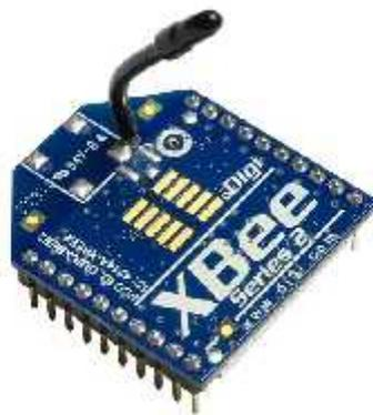
Gambar 2.7 Modul Xbee
