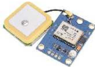
Gambar 2.6 Modul GPS NEO-6M
