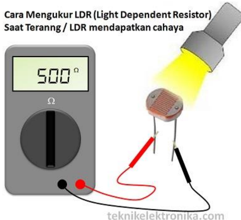
Gambar 2.13 cara mengukur Sensor LDR pada saat Terang
