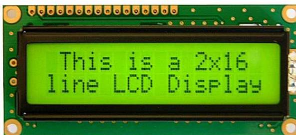
**Gambar 2.14.** Bentuk Fisik LCD 16x2
