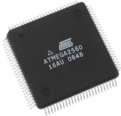
**Gamabar 2.4** IC ATMega 2560 pada Arduino Mega 2560
