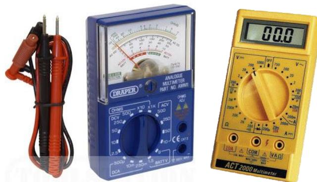
**Gambar2.19.** Multimeter Analog dan digital
