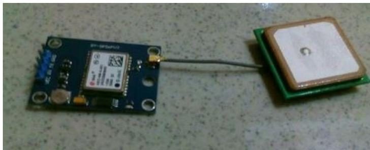
**Gambar 2.6** Modul GPS APM2.5 Neo-6M
