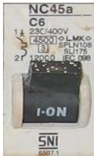
Gambar 2.23 MCB nameplat dengan kode dan simbol
