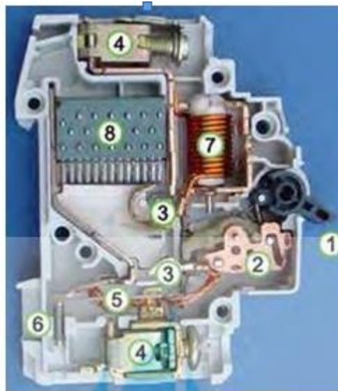
Gambar 2.25 Bagian bagian MCB
