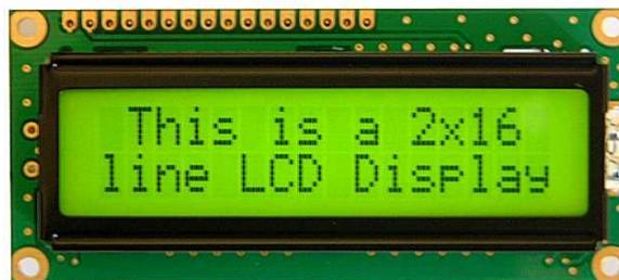
**Gambar 2.21** Bentuk Fisik LCD 16x2
