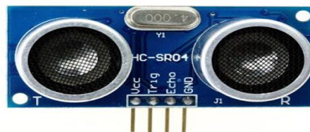
Gambar 2.3 Sensor Ultrasonik HC-SR04 (Panduan Praktis Arduino untuk Pemula, 2015)
