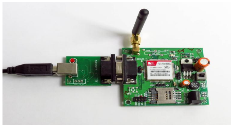
Gambar 2.19 Konfigurasi Port Data Modem GSM SIM900
