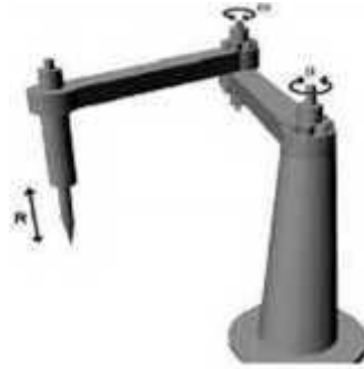
Gambar 2.5 Struktur Robot SCARA
