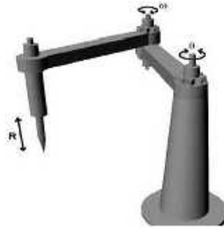
**Gambar 2.5** Struktur Robot SCARA
