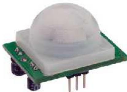
**Gambar 2.1** Bentuk Fisik Sensor PIR
