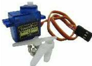
**Gambar 2.11** Bentuk Fisik Motor Servo
