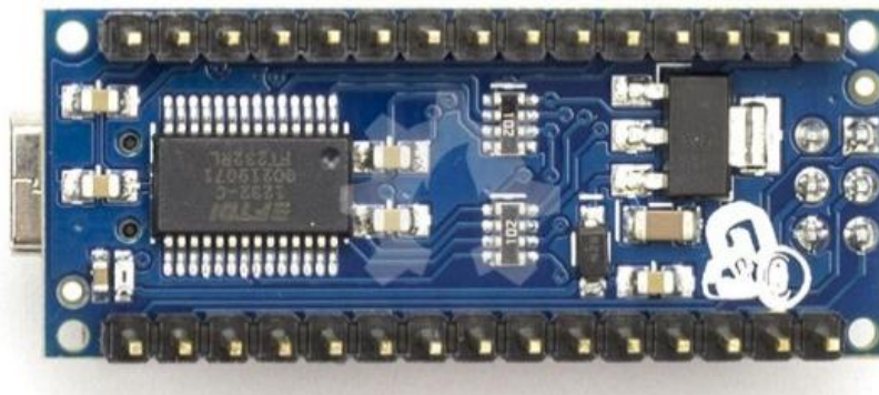
Gambar 2.15 Arduino Nano Bagian Belakang
