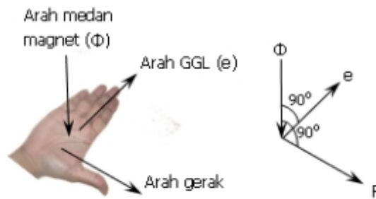
Gambar 2.2 Arah gerak GGL dengan kaidah tangan kanan
