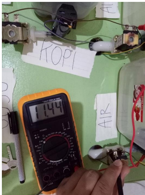
Gambar Pengukuran Tegangan Solenoid Valve Pada Minuman Teh Susu Pada Solenoid Valve Gula
