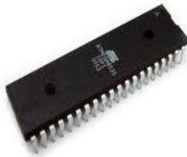
**Gambar 2.4** IC Mikrokontroller Atmega8535
