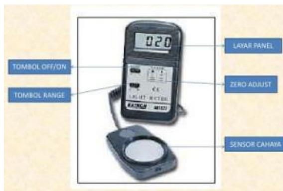
**Gambar 2.21** Bagian- bagian dari Alat Lux Meter
